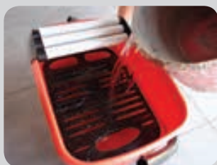
Grille amovible munie d'un système anti-vagues
