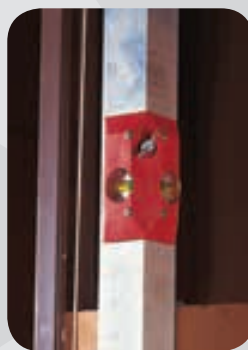
Niveaux incorporés et blocage de la règle
