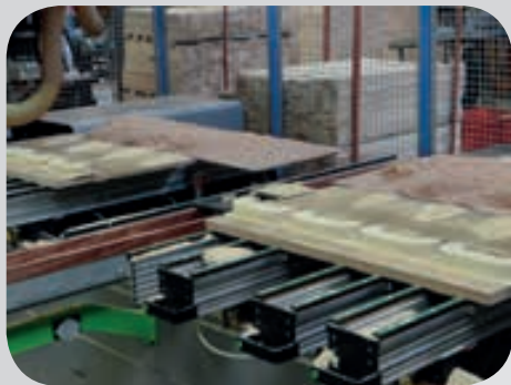
Réalisation de poignées sur notre centre d'usinage à commande numérique.
