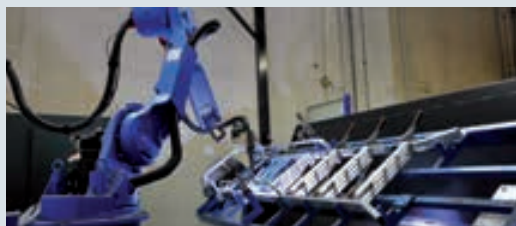
Soudure robotisée pour un cordon toujours identique.
