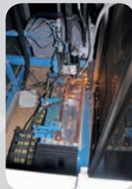
Soudure des rivets sur la lame
