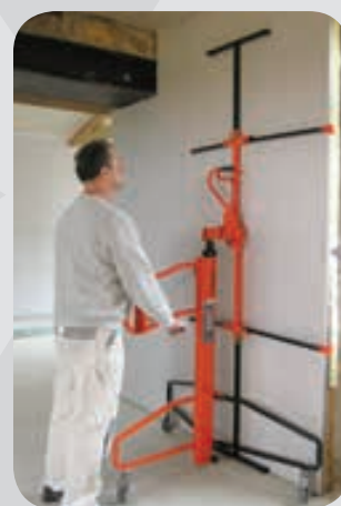
Pose verticale jusqu'à 5,90 m (usage non intensif, sinon privilégier le LEVPANOCOMBI®)
