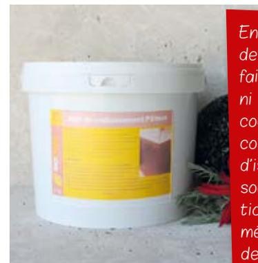
Enduit à base d'émulsion de bitume. L'application se fait à froid, sans mélange ni chauffage. Fort pouvoir couvrant et collant : collage des matériaux d'isolation, étanchéité des soubassements, protection des matériaux (bois, métal, zinc) et isolation de terrasses.
